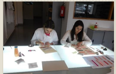
Figura 7- Preparação das amostras com aplicação de riscadores e tintas.
