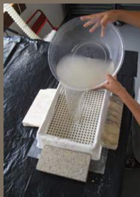
Imagem 9 - Verter a polpa para o interior da estrutura.
