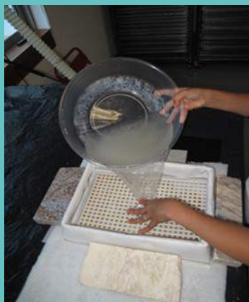
Imagem 13– Verter a polpa para o interior da estrutura.
